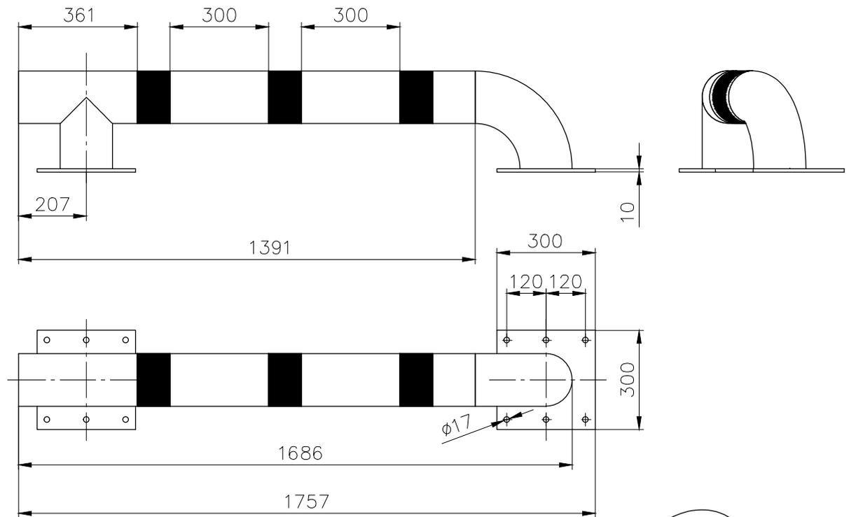
Rohr  $\phi 150 \times 3$  mm
