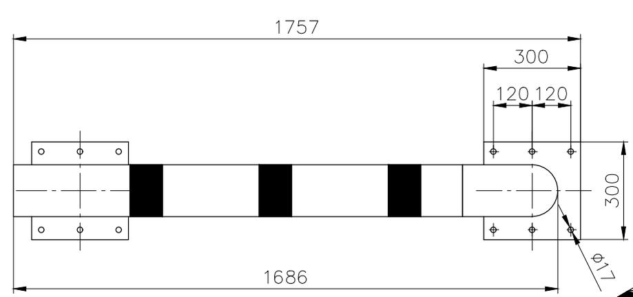
Rohr  $\phi 150 \times 3$  mm
