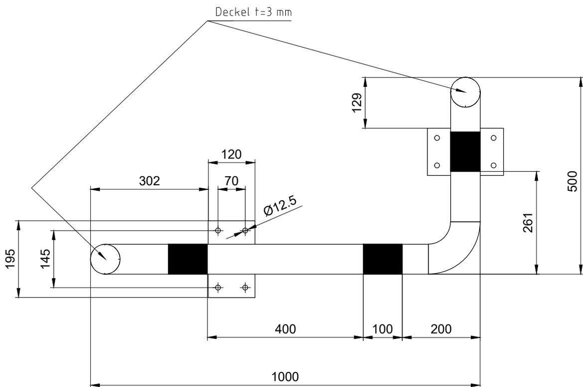
Stahlrohr Ø76,1 x 2,9 mm
