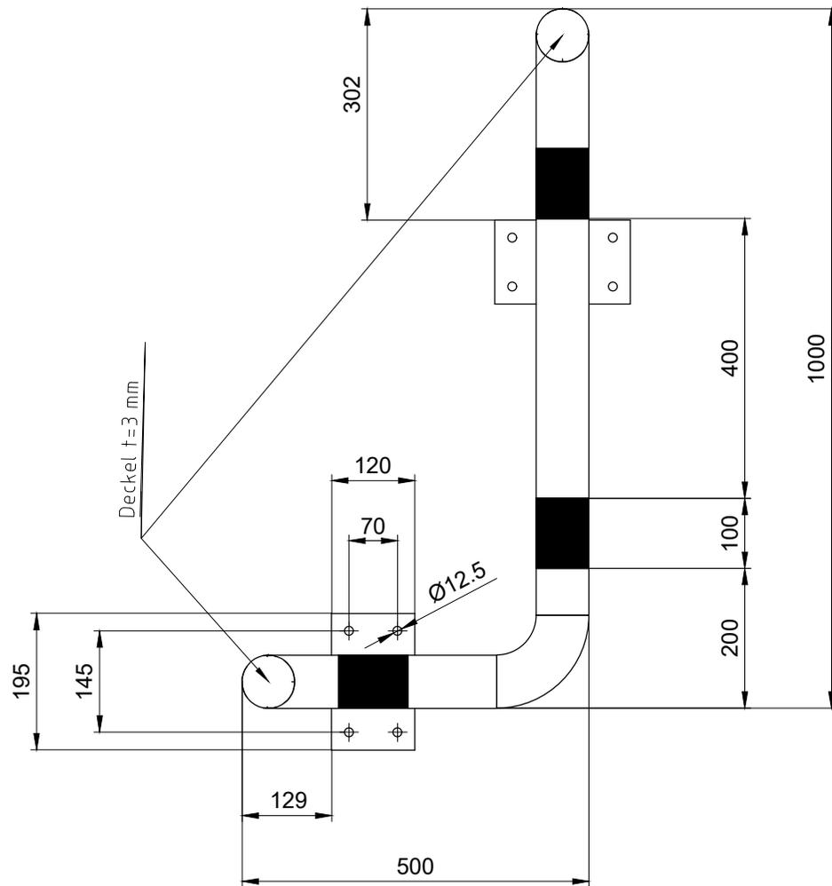
Stahlrohr  $\text{Ø}76,1 \times 2,9 \text{ mm}$
