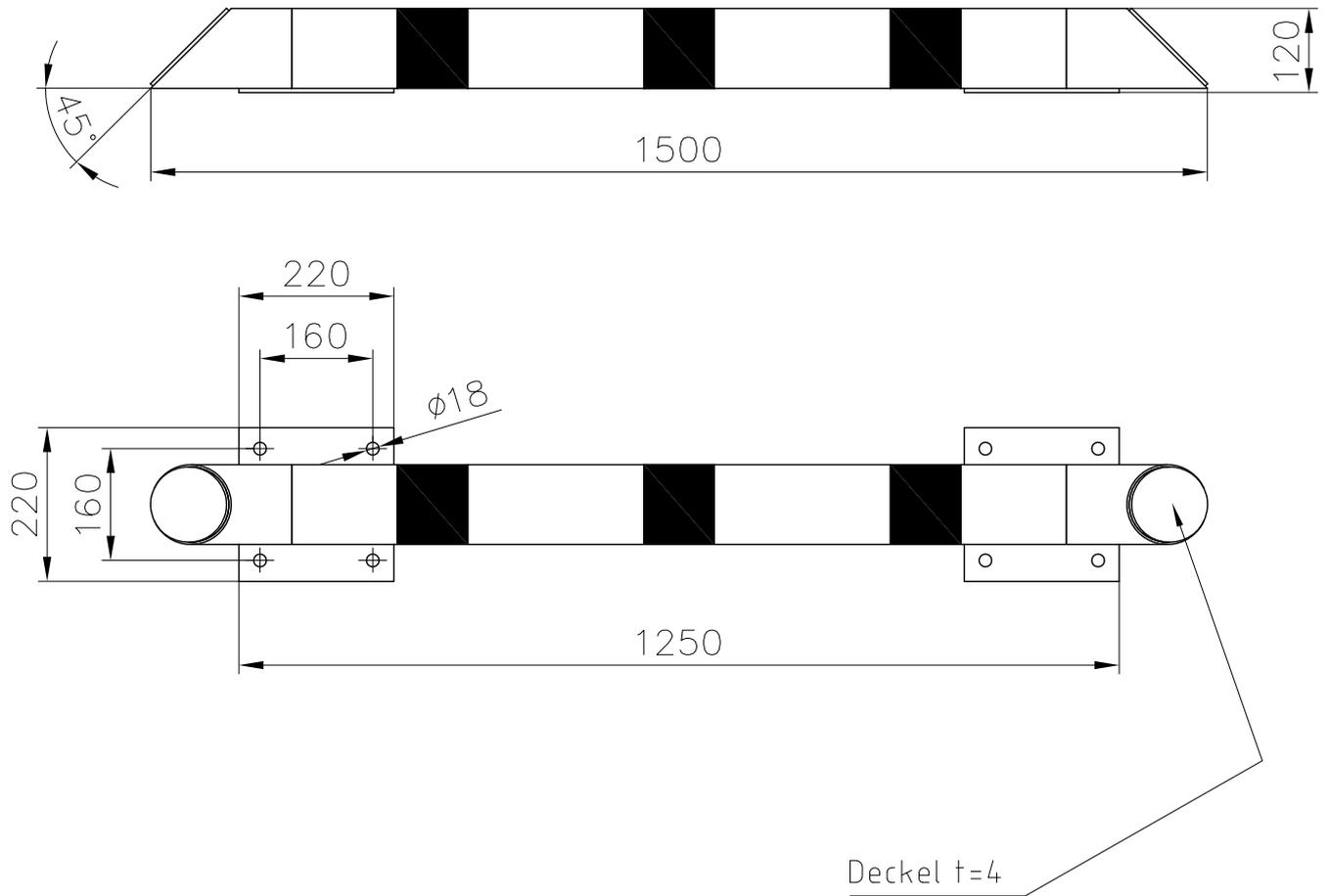
Stahlrohr  $\varnothing$  114,3 x 3,2 mm
