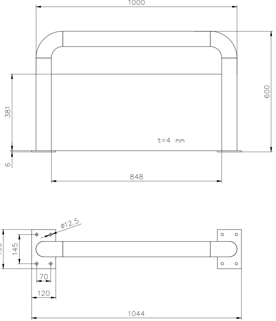
Stahlrohr Ø76,1 x 2,9 mm
