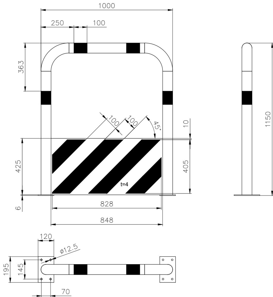
Stahlrohr Ø76,1x 2,9 mm
