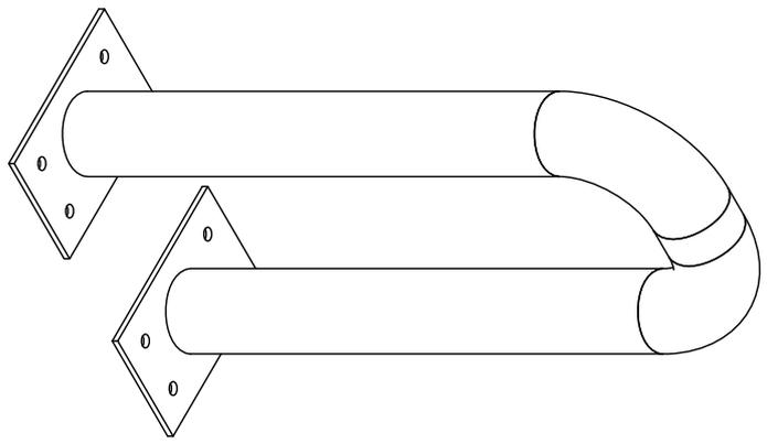
Stahlrohr  $\varnothing$  76, 1x 2,9 mm
