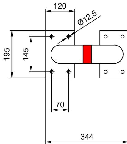
Stahlrohr  $\text{Ø}76,1 \times 2,9 \text{ mm}$
