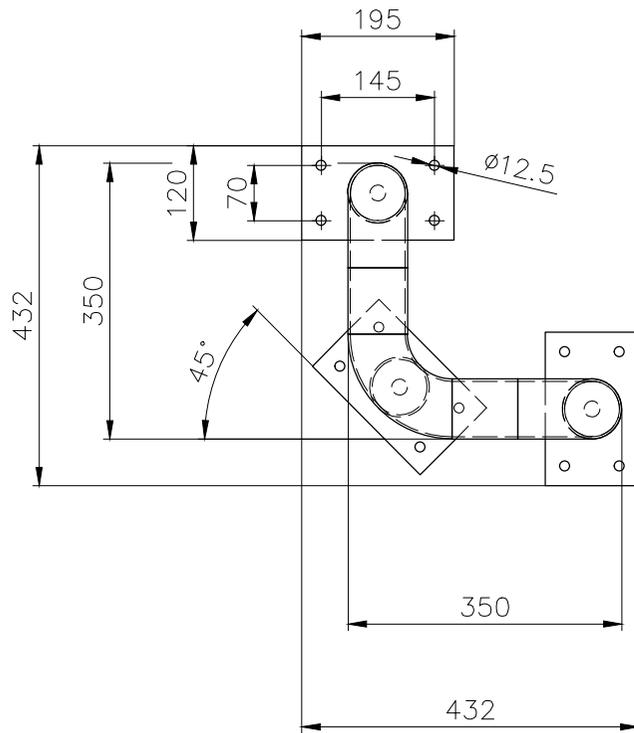
Stahlrohr Ø76,1x 2,9 mm
