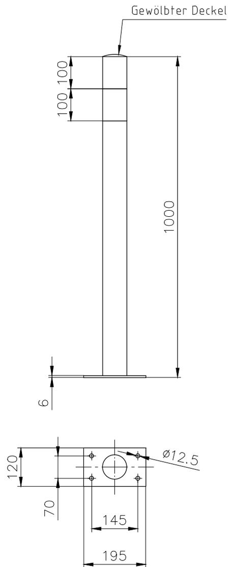
Stahlrohr  $\text{\O} 76,1 \times 2,9 \text{ mm}$
