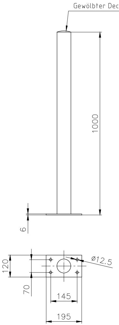
Stahlrohr Ø 76,1x 2,9 mm
