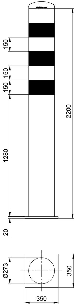
Stahlrohr  $\text{\O} 273 \times 6,3 \text{ mm}$
